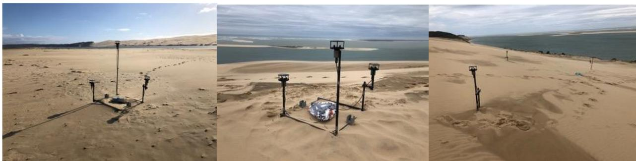
Figure 3 à 5 : Instruments de mesure du vent sur le banc d'Arguin et la dune du Pilat (Photo IPGP)
